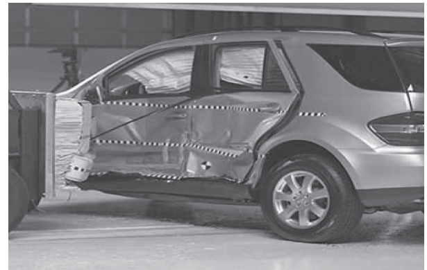
شکل ۲. رنگ درب خودرو بنز که با فناوری نانو تهیه شده مشاهده می شود که پس از ضربه شدید نیز رنگ بدنه کاملاً سالم می باشد
